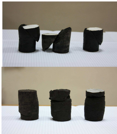
Рисунок 1 - Характер руйнування зразків ґрунта (ІґЕ №31) за схемою неконсолідовано-дренованих і консолідовано-дренованих випробувань
