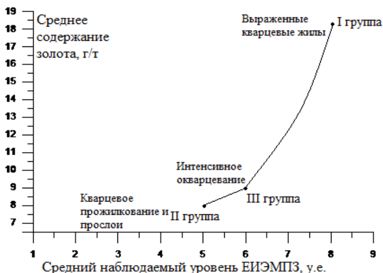
Рис. 1 График взаимосвязи уровня поля ЕИЭМПЗ (у.е.) и осредненного содержания золота в скважинах (г/т) для выделенных групп пород y=0,945x+0,270 ; R^2=0,965
